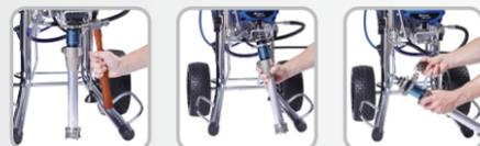
Desserrer l'écrou de serrage
